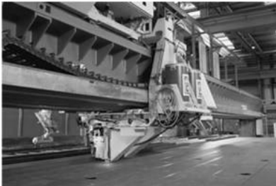
Figura 19 – Equipamento de soldadura híbrida automática
