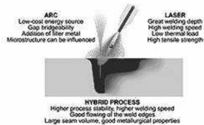
Figura 16 – Soldadura híbrida laser – plasma
